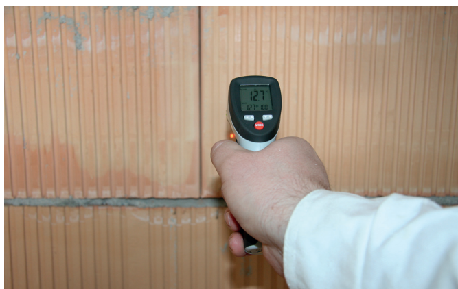
Meranie teploty povrchu
