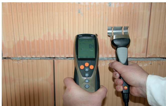
Meranie kontaktným vlhkomerom
