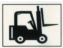
Bod uchopenia vyso- kozdvížným vozíkom
