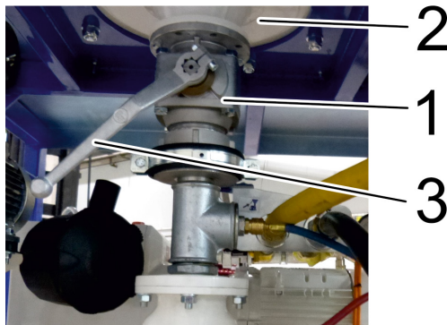
Obr. 17: Guľový kohút na príruby adaptéra
