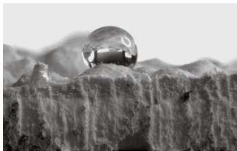
Kvapka vody na hydrofóbnom povrchu štandardnej omietky
