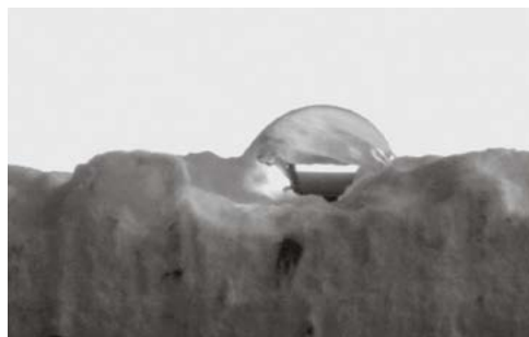
Kvapka vody na hydrofilnom povrchu omietky Baumit NanoporTop
